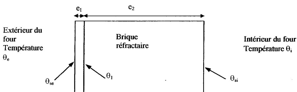
On rappelle que la résistance thermique  $R$  s'exprime en fonction de la différence de température  $\Delta\theta$  et du courant thermique  $\phi$  :  $R = \frac{\Delta\theta}{\phi}$ .
