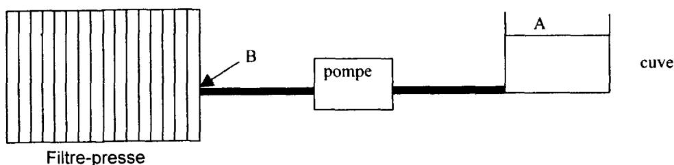
Le technicien responsable de la machine doit choisir la pompe servant à véhiculer la barbotine dans le filtre-presse. Il doit déterminer la puissance de celle-ci.
